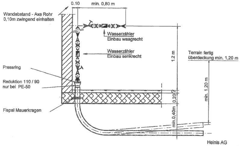
Hauswasseranschluss PE 40 - 63 mm in Futterrohr 92 / 80 - 112 / 100
